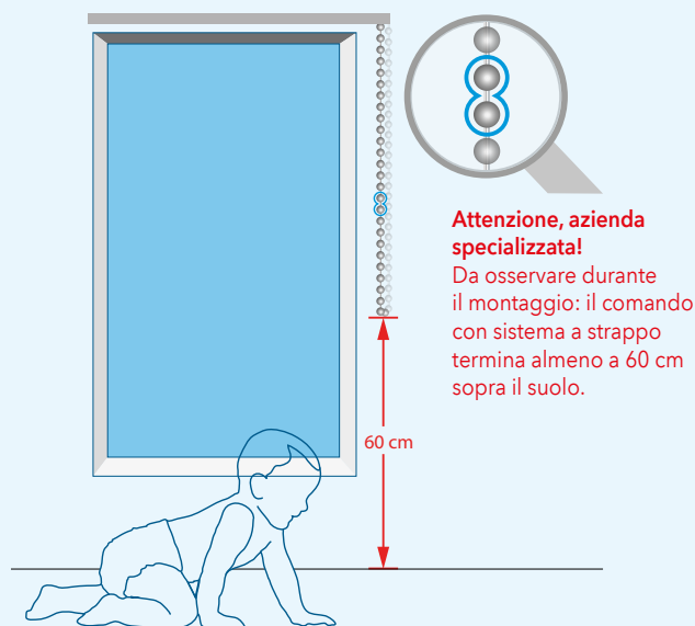
Fig. 1 COMANDO A CATENA CON PROTEZIONE CONTRO I SOVRACCARICHI (SISTEMA A STRAPPO)
