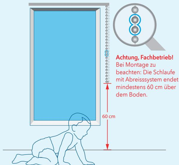
**Abb. 1** KETTENBEDienung MIT ÜBERLASTSICHERUNG (ABREISS-SYSTEM)
