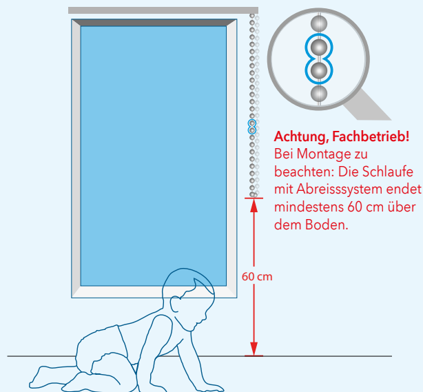
Abb. 1 KETTENBEDIENUNG MIT ÜBERLASTSICHERUNG (ABREISS-SYSTEM)
